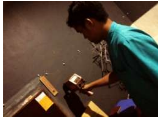
Gambar 2. Pengukuran dengan menggunakan Survemeter
